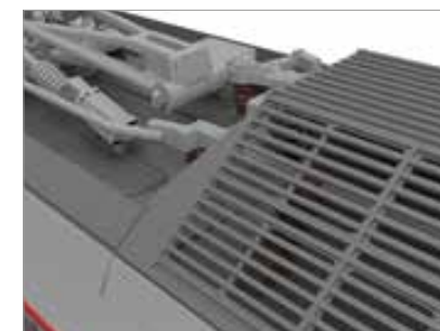
■ Struttura del tetto traforata in lamiera acidata
