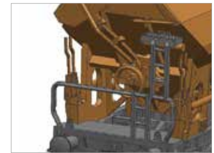
■ Elaborata replica della piattaforma di manovra e delle leve autoportanti
