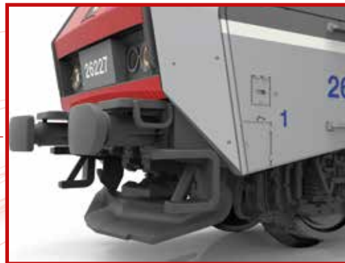
■ El amortiguador se puede equipar con las piezas suministradas
