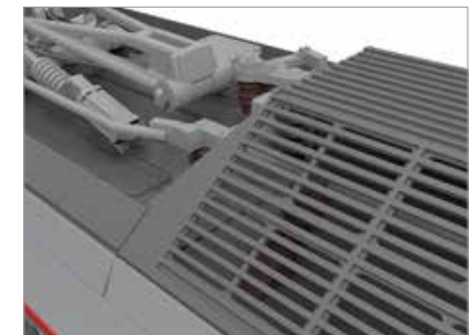
■ Structure de toit ajourée en tôle gravée
