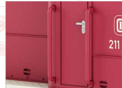
■ Cabina maquinista con barras de agarre sobresalientes
