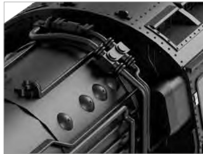
■ Tubulures détachées devant la cabine
