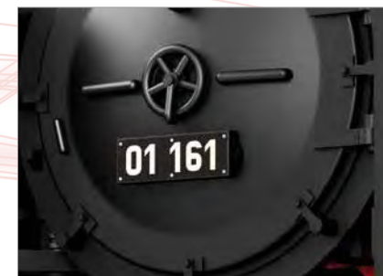
■ Porte de la boîte à fumée avec fermeture centrale
