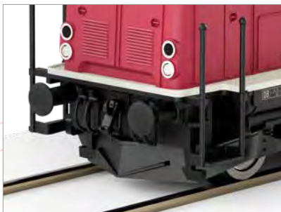
■ Avec chasse-neige fidèle au modèle réel
