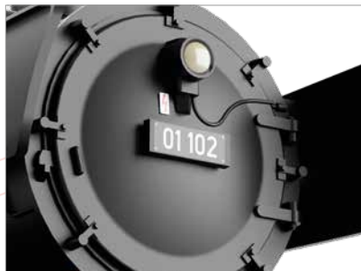
■ Versione della camera di fumo fedele all'originale
