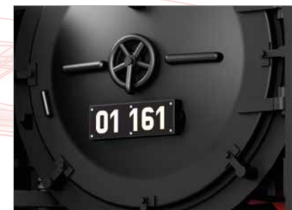
■ Porta camera fumo di con chiusura centralizzata
