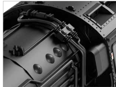
■ Linee autoportanti davanti alla cabina di guida
