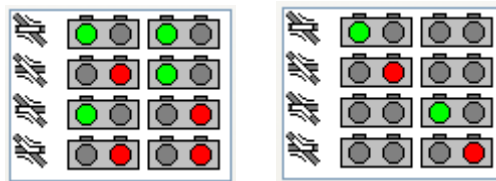
Abbildung 36: Anschlussbelegung einer Doppelkreuzungsweiche einstellen
