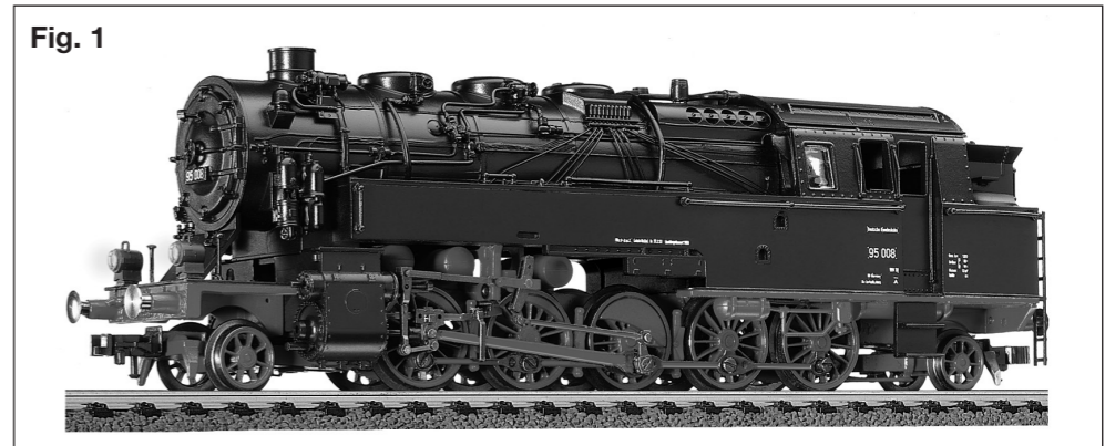
Fig. 1: Zu den Giganten unter den deutschen Tenderlokomotiven zählten die Maschinen der preußischen Gattung T 20, spätere Baureihe 95.0, von denen die ersten Exemplare 1922 in Dienst gestellt wurden. Zur DB gelangten 14 Stück. Sie waren beim Bahnbetriebswerk Aschaffenburg stationiert und leisteten schwere Schubdienste auf der Spessarthrampe zwischen Laufach und Heigenbrücken.
