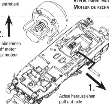
Ein Öffnen der Lok ist nur nötig zum Lampenwechsel, Motorenwechsel und Ölen des Getriebes.
