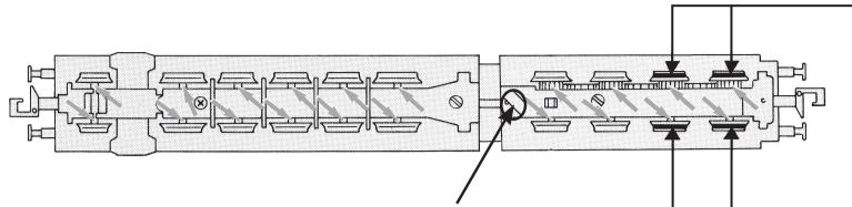
An der markierten Stelle kann der Schaltmagnet 942701 eingebaut werden.
