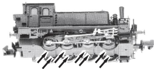
**Reinigen der Lokräder:** Bei Verschmutzung sind die Laufflächen der Räder mit sauberem Lappen oder Schienenreinigungsgummi 6595 zu reinigen. Niemals die angetriebenen Räder von Hand durchdrehen, sondern durch Anlegen einer Fahrspannung mittels Anschlussdrähten antreiben. Nichtangetriebene Räder können von Hand gedreht werden.
