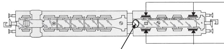
An der markierten Stelle kann der Schaltmagnet 942701 eingebaut werden.
