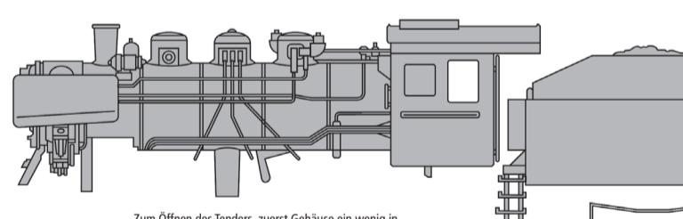
Zum Öffnen des Tenders, zuerst Gehäuse ein wenig in Richtung Führerhaus schieben, dann abheben.
