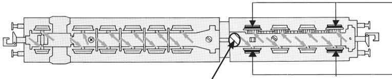
An der markierten Stelle kann der **Schaltmagnet 942701** eingebaut werden.
