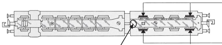
An der markierten Stelle kann der Schaltmagnet 942701 eingebaut werden. The indicated point can be used for locating the switching magnet 942701. L'aimant permanent 942701 peut être monté à l'endroit indiqué.
