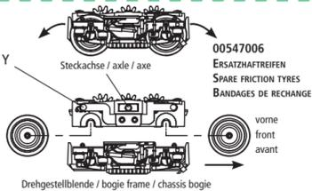
Beim Zusammenbau auf richtige Lage der Kontaktfedern Y achten. Radsätze von Drehgestellmitte aus über die Kontaktfedern einsetzen.
