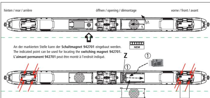
An der markierten Stelle kann der Schaltmagnet 942701 eingebaut werden. The indicated point can be used for locating the switching magnet 942701. L'aimant permanent 942701 peut être monté à l'endroit indiqué.
