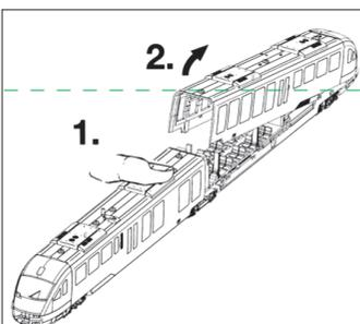
**Öffnen:** Nur zum Motorwechsel. Ein Gehäuse festhalten, das Andere kann dann nach oben abgezogen werden.
