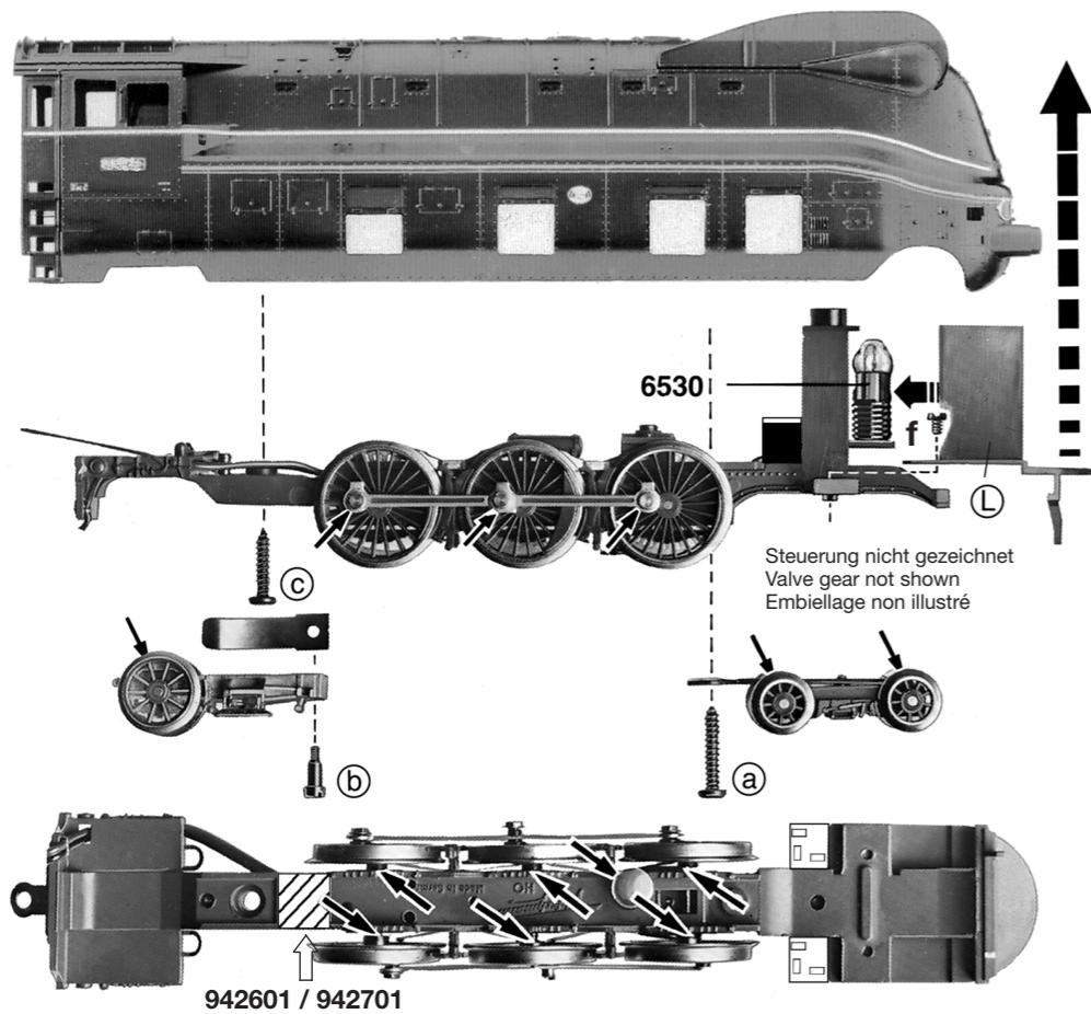
Ein Öffnen der Lok ist nur zum Lampenwechsel erforderlich. Schrauben **a**, **b** und **c** entfernen, Lokgehäuse seitlich spreizen und abziehen, beide Schrauben (**f**) seitlich des Schornsteines entfernen, Lichtabdeckung **L** nach vorne abziehen.
