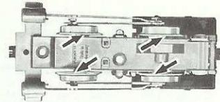
**Öffnen:** Ein Öffnen der Lok ist nur zum Schleifkohlenwechsel und Ölen der Motor- und Getriebelager erforderlich.
