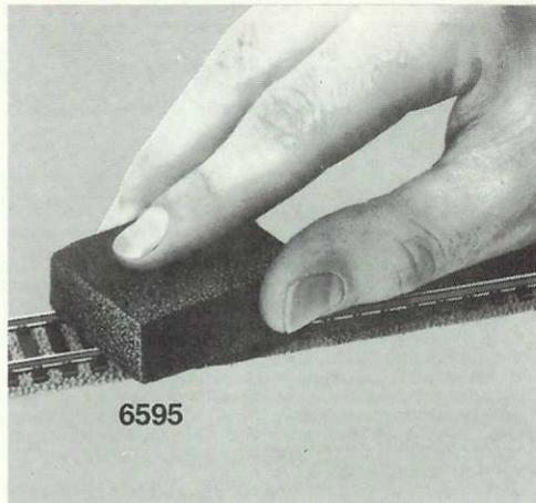
**Rengöring av lokhjul:** Vid nersmutsning av hjulens köryta (→): rengör hjulen med en ren tygtrasa eller **rengöringsgummi 6595**. **Vrid aldrig runt drivhjulen för hand**, utan lägg mot anslutningskabel med körsänning av **max. 14 V<sup>~</sup>**. Hjul som inte är drivhjul kan vridas för hand.
