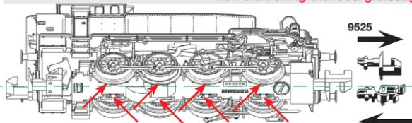
Lok öffnen/open the loco/ouvrir loco
