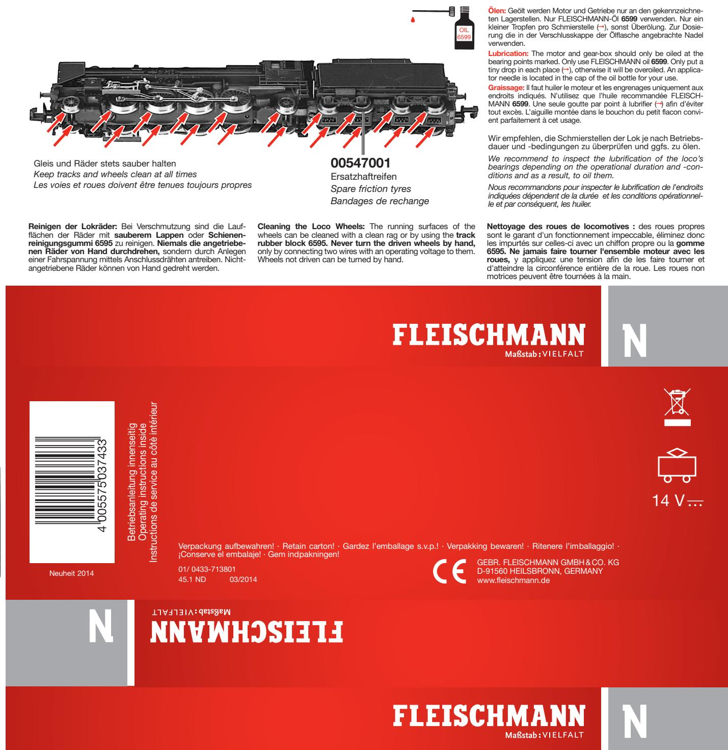
Ein Öffnen der Lok ist nur zum Lampenwechsel, ein Öffnen des Tenders nur zum Lampenwechsel, zum Schleifkohlenwechsel und Ölen der Motorlager erforderlich.
