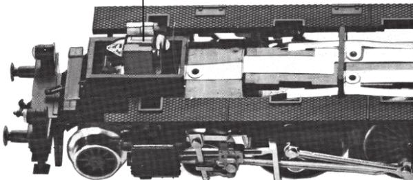
**Einbau eines digitalen Empfängerbausteins:** Auf der schraffierten Fläche **y** kann ein **DECODER (DCC: 685301)** mit 6-poligem Stecker **(NEM 651)** geklebt werden. Beim Einbau bitte die Betriebsanleitung des jeweiligen DECODERS beachten.
