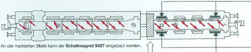
An der markierten Stelle kann der Schaltmagnet 9427 eingebaut werden.
