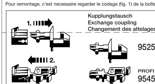
Beim Kupplungstausch (siehe 3) von unten so auf das Drehgestell drücken, dass die Kupplungsdeckel fixiert wird. Danach die Kupplung vorsichtig einstecken bzw. herausziehen.
