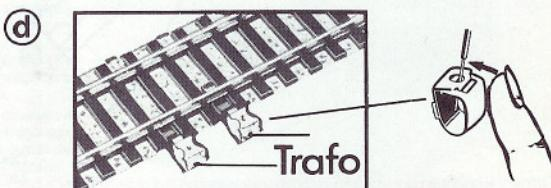
Durch Drücken der Trafoanschlußklemme wird Öffnung frei zum Einführen des abisolierten Drahtstückes. Beim Loslassen feste Klemmverbindung.
