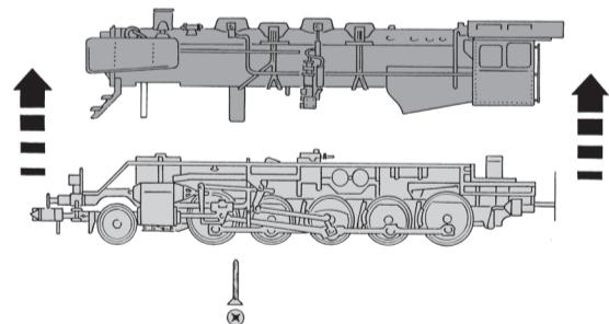
Beim Aufsetzen des Gehäuses ist darauf zu achten, dass die im Tendergehäuse eingenietete Kontaktfeder nicht verbogen wird!
