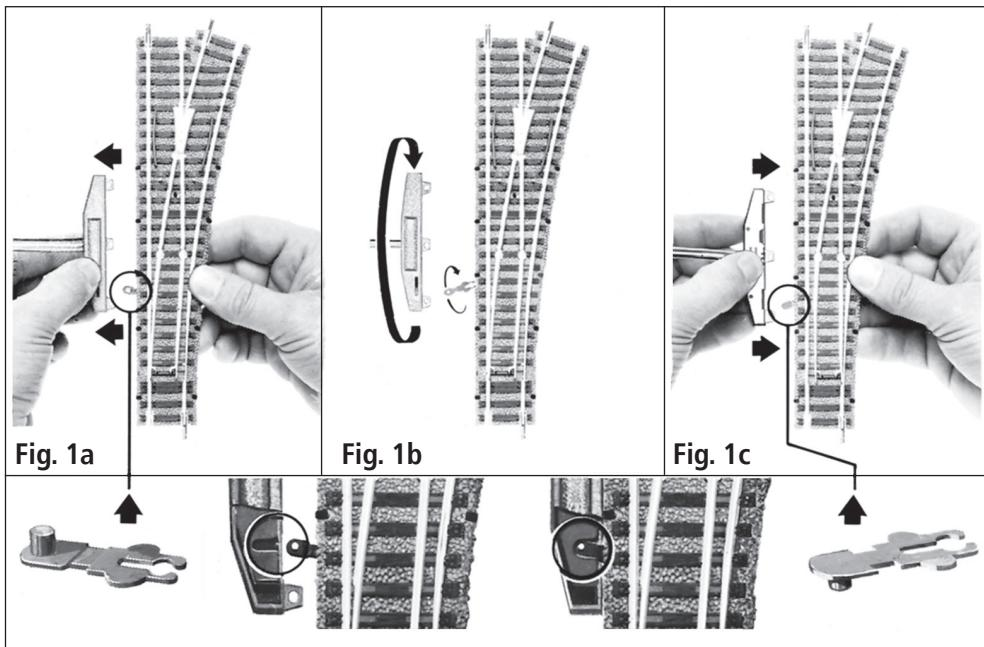
Die Weichenantriebe sind aufsteckbar und besitzen eine Überlastsicherung, die nach Überbelastung nach ca. 1 Min. wieder einschaltet. Überbelastung tritt auf, wenn der Antrieb nicht die Endstellung erreicht, aber auf Dauer eingeschaltet bleibt. Achtung: Nach häufiger Überbelastung kann die Sicherung auf Dauer abschalten!
