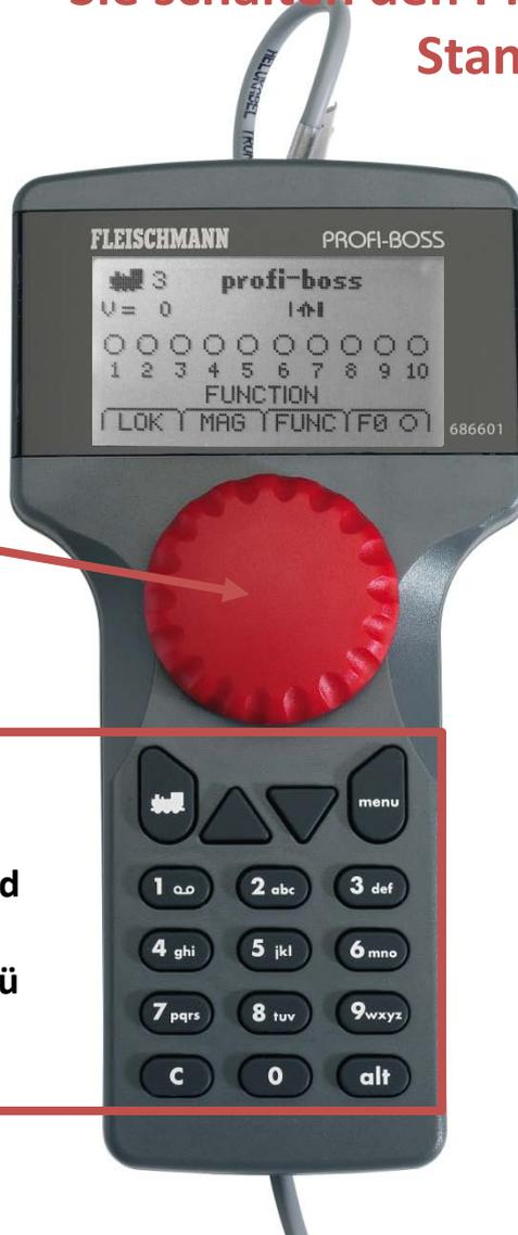
Tastenblock alphanumerisch und Sondertasten zur Navigation im Menü
