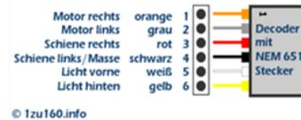
Der 6 polige *Decoder* oder der *Brückenstecker* kann auch für die PluX-Schnittstelle verwendet werden!
